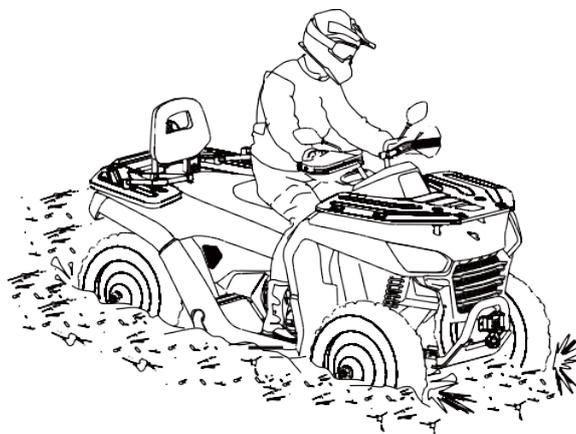
Su ATV puede operar en el agua con una profundidad máxima recomendada igual a la altura de la parte inferior de los reposapiés. Siga estos procedimientos:
