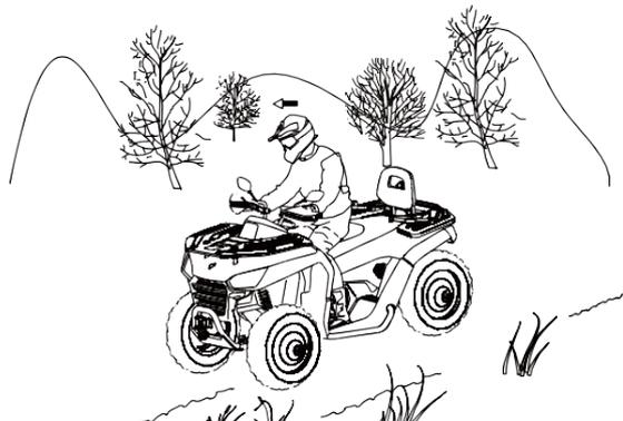
No se recomienda conducir alrededor de las montañas. Esta maniobra puede causar pérdida de control o vuelco. Evite este tipo de conducción y solo hágalo cuando sea estrictamente necesario. Si no tiene alternativa:
