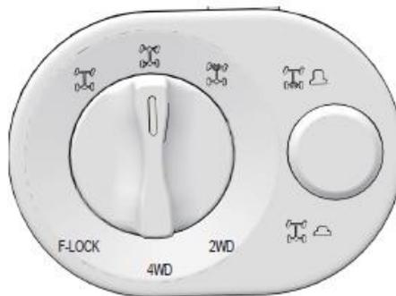
Precaución: El vehículo debe estar parado siempre que desee conectar o desconectar los modos de conducción 2x4 (2WD) o 4x4 (4WD). Si intenta cambiar el modo de conducción mientras conduce, podría causar daños graves a su vehículo.
