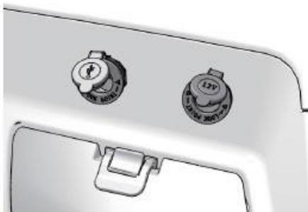
El vehículo dispone de dos tomas para accesorios (USB y CC), con una potencia máxima de salida de 12V. El encendido debe estar en la posición "ON" para que estas tomas tengan corriente.
